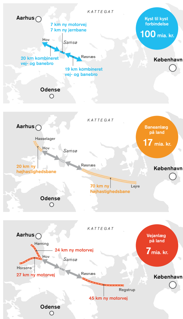
Figur 4 Anlægsomkostningerne til henholdsvis de to faste broforbindelser, samt jernbaner og motorveje på landsiderne.
