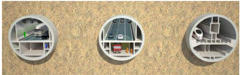
Figur 5-61 Et eksempel på en boret tunnel konfiguration (Femern koncept design)
