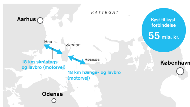
Figur 7.1 Anlægsomkostningerne for de to broforslag.
